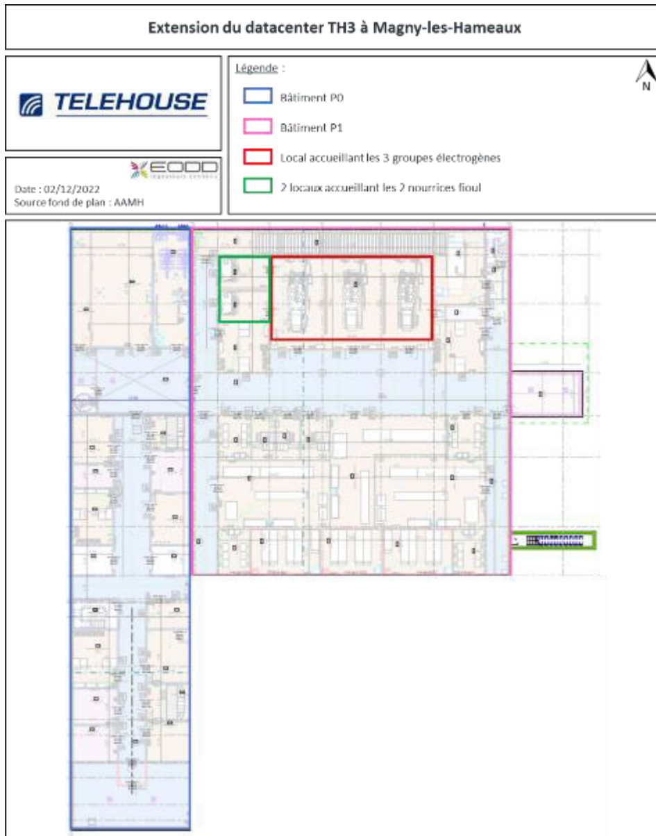
Figure 22 : Groupes électrogènes et nourrices fioul au sous-sol du bâtiment P1
