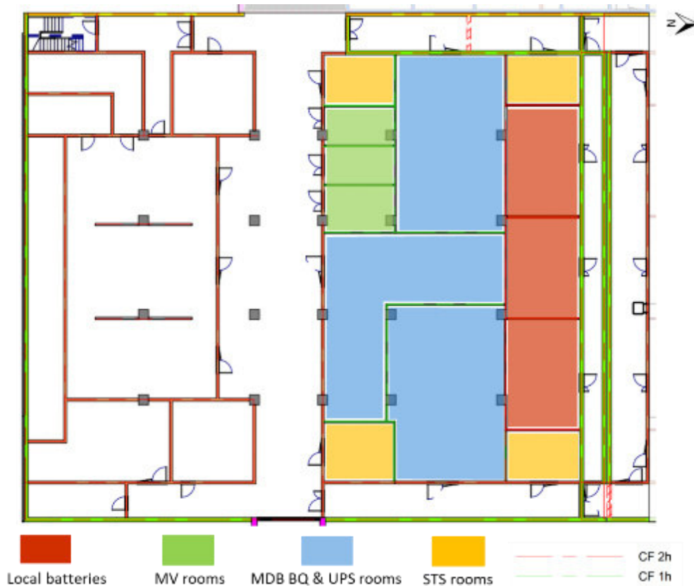
Figure 38 : Identification des locaux électriques au sous-sol du bâtiment P2 et murs coupe-feu
